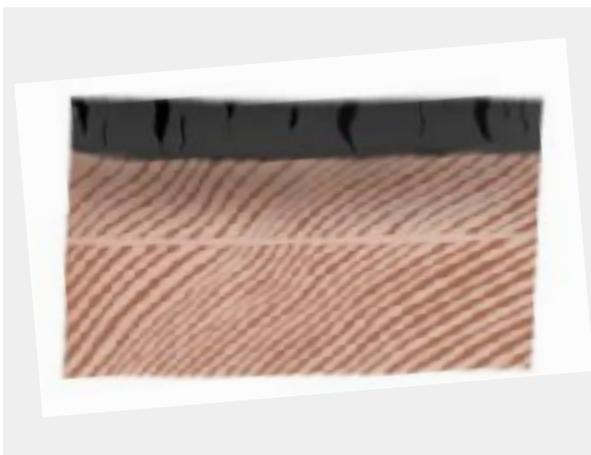
A camada superior as temperaturas pode ficar entre 300°C a 500°C. A estrutura da madeira é carbonizada e ocorre a saída dos produtos voláteis, essa camada pode ter de 1 a 3 mm de espessura.
